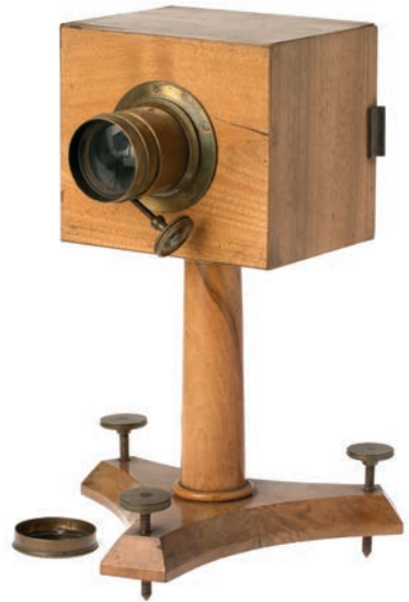
Kamera ympärysmitaltaan 90 mm:n kokoisille, pyöreille daguerrotyypilevyille, GEH Smetanan kamera, 1840 jälkeen. Petzval-tyyppinen objektiivi, kuvaformaatti 7,2 x 8,1cm, NTM
